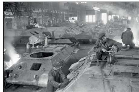
Сборка танка на заводе «Красное Сормово»
